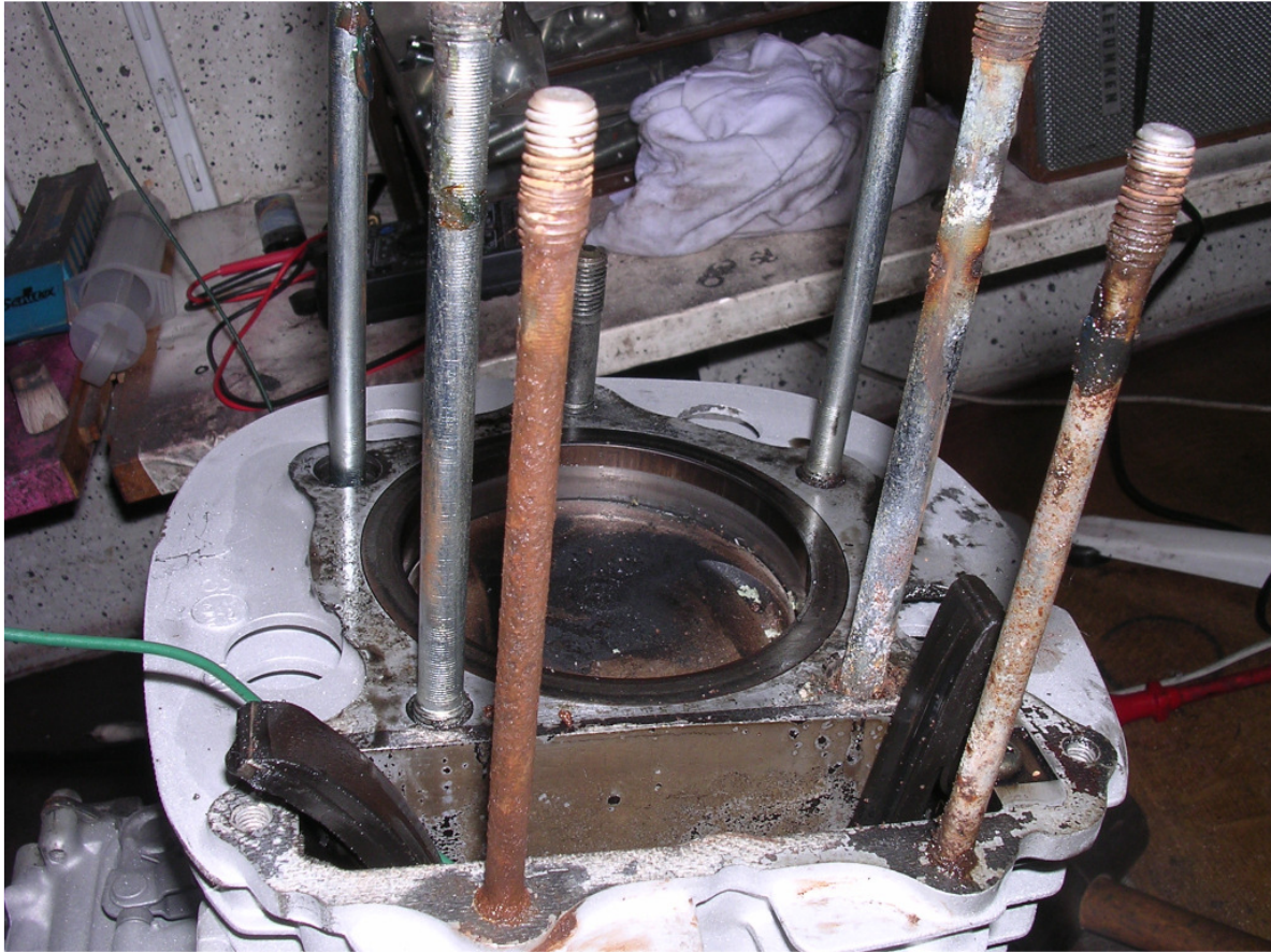
Und die nächste Sauerei ... Rost.. Wasser bä...und wieder alles in blau geklebt...
