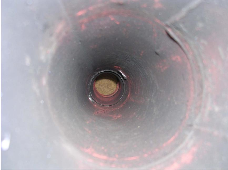
Die weichen hinteren Befestigungen brechen beidseitig ab und können bis in die Reflexionskammer verschwinden, die man nur durch Öffnen von ganz hinten wieder entfernen kann. (s. letztes Bild hinten)
