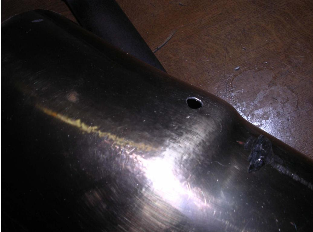
(die Bohrung war Sondage , um lockere Teile evtl . zu erkennen (GF-Optik)
